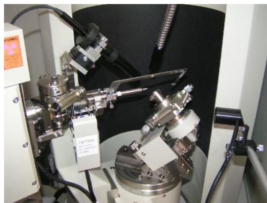
Fot. 3. Dyfraktometr rentgenowski D/max RAPID II-R firmy Rigaku (Japonia). Lampa rentgenowska z wirującą anodą o mocy 18 kW.
