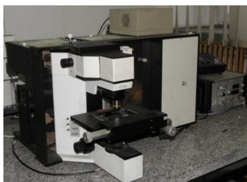
Fot. 5. Spektrometr ramanowski LabRam firmy Jobin-Yvone z mikroskopem konfokalnym; wyposażenie: laser argonowy (514 nm, moc 300
